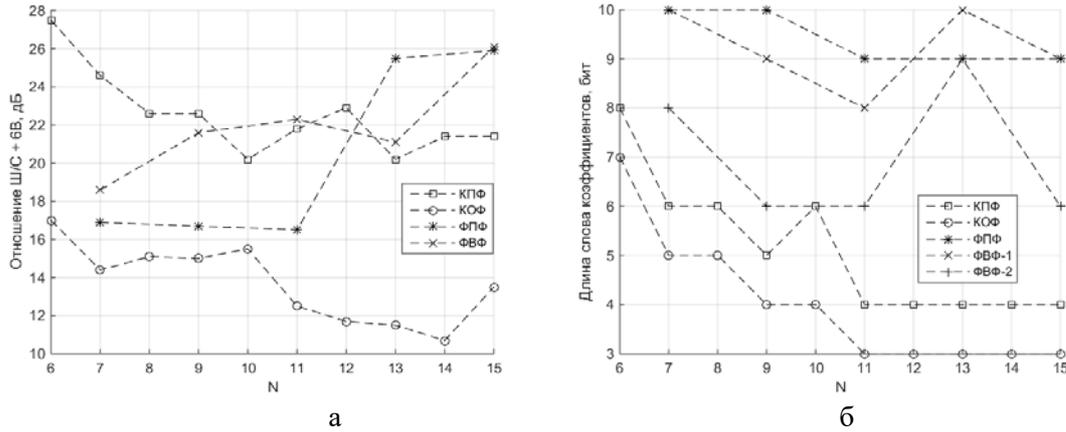
Рисунок 2. Зависимости отношения Ш/С при квантованных коэффициентах (а) и длины слова коэффициентов (б) от порядка фильтров для четырех структур
