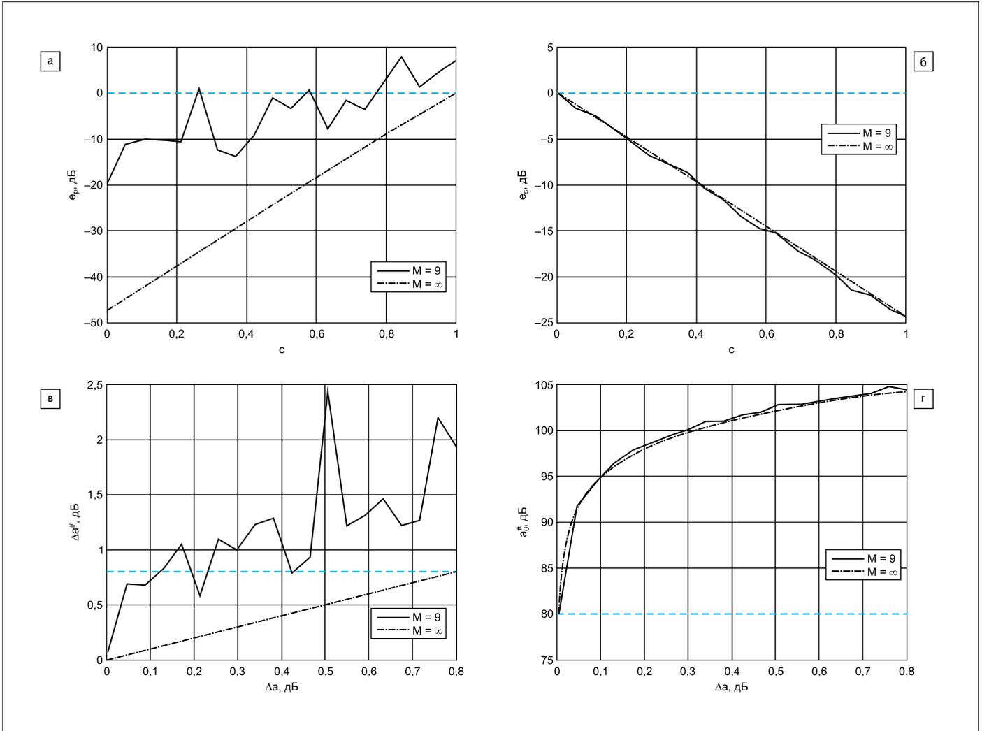
Рис. 1. Зависимости для структуры КПФ: а) ошибки  $e_p$  от параметра  $c$ ; б) ошибки  $e_s$  от параметра  $c$ ; в) неравномерности  $\Delta a^{\#}$  от исходной неравномерности  $\Delta a$ ; г) ослабления  $a_0^{\#}$  от исходной неравномерности  $\Delta a$
