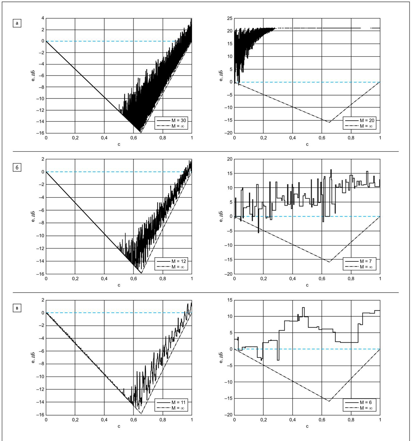
Рис. 4. Зависимости ошибки  $e$  от параметра  $c$  для трех структур фильтров: а) прямая форма; б) КПФ; в) КОФ
