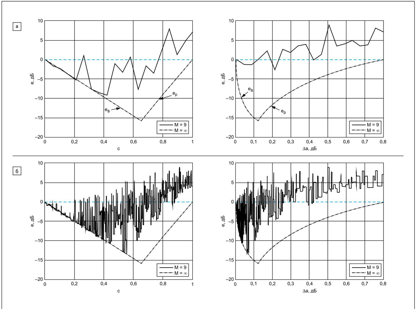
Рис. 2. Зависимости ошибки  $e$  от параметров  $c$  и  $\Delta a$  для структуры КПФ: а) малое число точек параметров; б) большое
